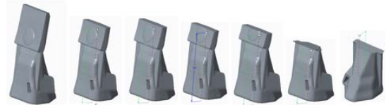
Gbr. 9 Hasil pengukuran periodik yang telah dikonversi menjadi tinggi bidang aus rata-rata.
